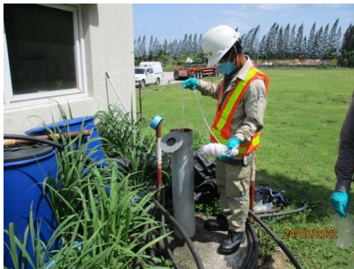
บ่อสังเกตการณ์ในทิศทางท้ายน้ำของการไหลของน้ำใต้ดิน จุดที่ 1
